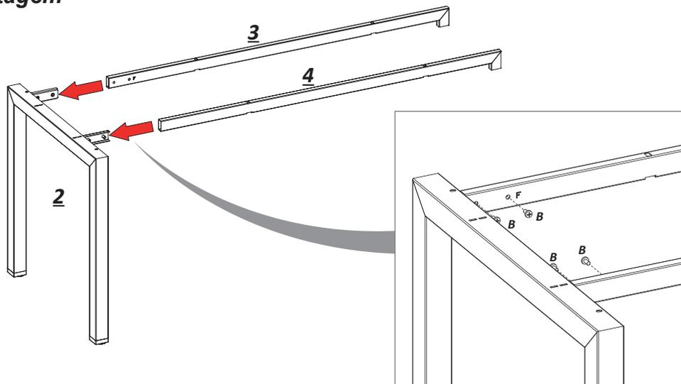
**2.1** Encaixe as travessas e fixe com os parafusos indicados.
